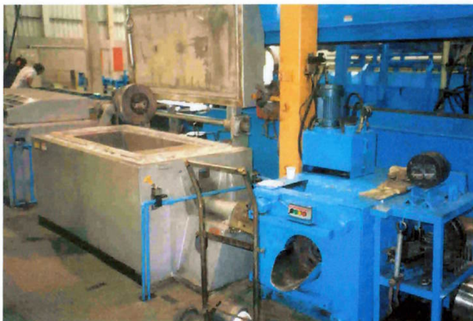
Fig.6. Detalhe de forno de aquecimento e dispositivo aonde se desmonta a ferramenta.
